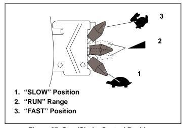
Figure 27. Start/Choke Control Positions
